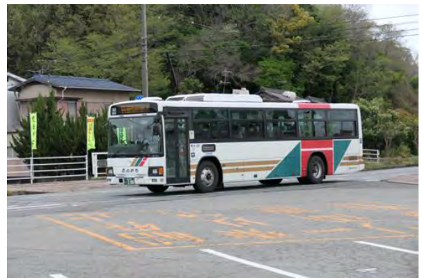
図 37 自動車専用道路走行に対応したバス車両(いずれもツーステップ車両)
